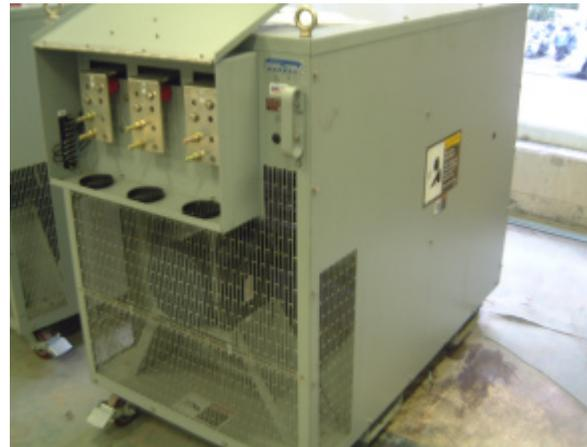
250kW @ 380V 移動式電阻性負載器
