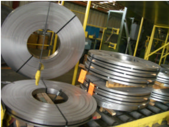
盤管原料..鋼捲.1
