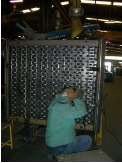
水槽內盤管組試壓 200psi/20min
